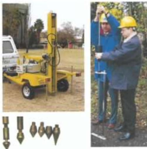
Gambar 2. Alat uji DCP otomatis, alat Uji DCP Manual dan Ujung Konus DCP
